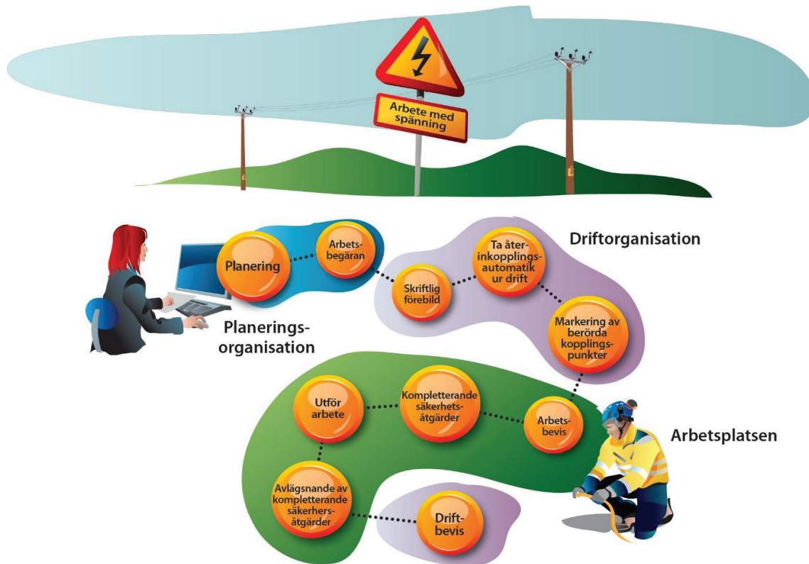
Bild 34. Exempel på arbetsflöde vid arbetsmetod Arbete med spänning.
