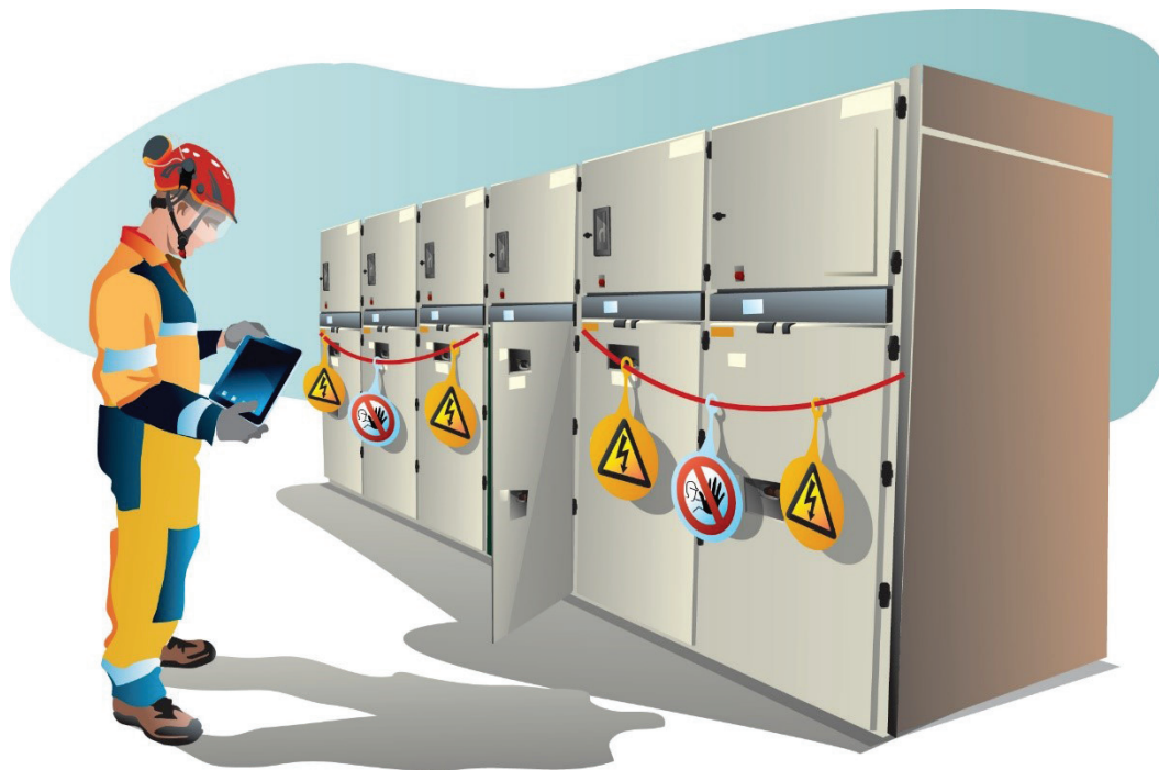
Bild 20. Exempel på avspärrningslina på ställverk.
