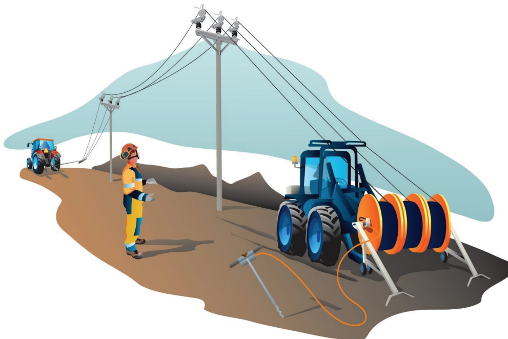
Bild 19. Exempel på potentialutjämning mot jord vid lindragning.
