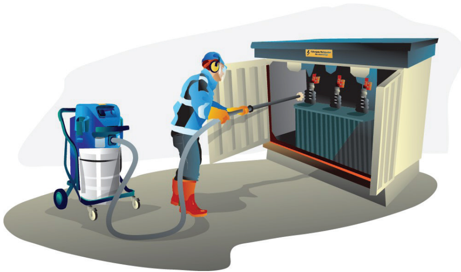
Bild 37. Ett exempel på teknisk rengöring av en transformator som utförs på både lågspänning och högspänning enligt en AMS-metod.
